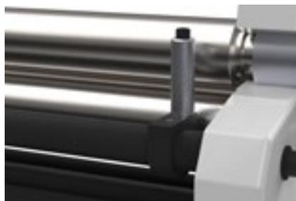
> Butée mobile pour aider au roulage des cônes
