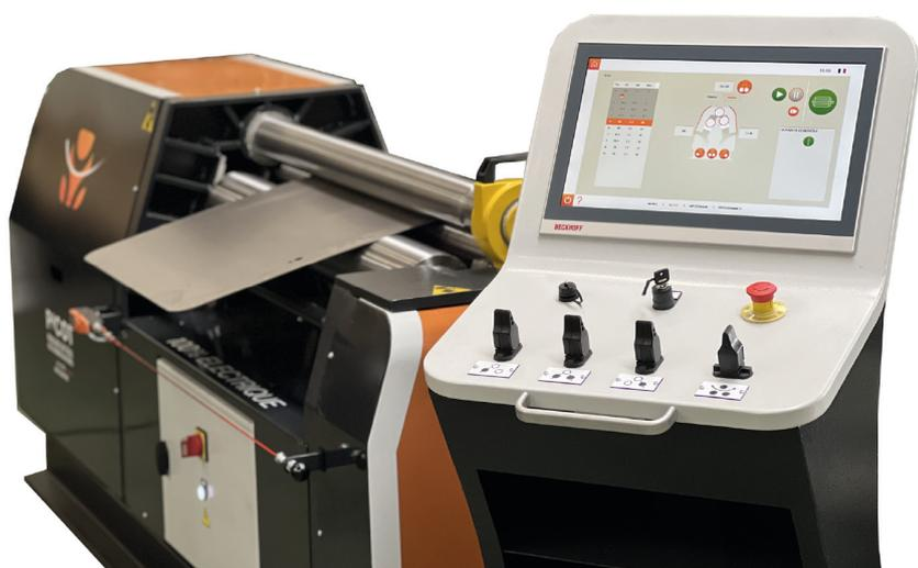
AMB PICOT vous propose son modèle R3h ou R3e spécialement adapté au roulage de la tôle Fine. Cette rouleuse, 100% hydraulique, ou 100% électrique vous est proposée en plusieurs versions : Academy, avec commande numérique ou avec commande numérique et assistance au roulage Easyroll.
