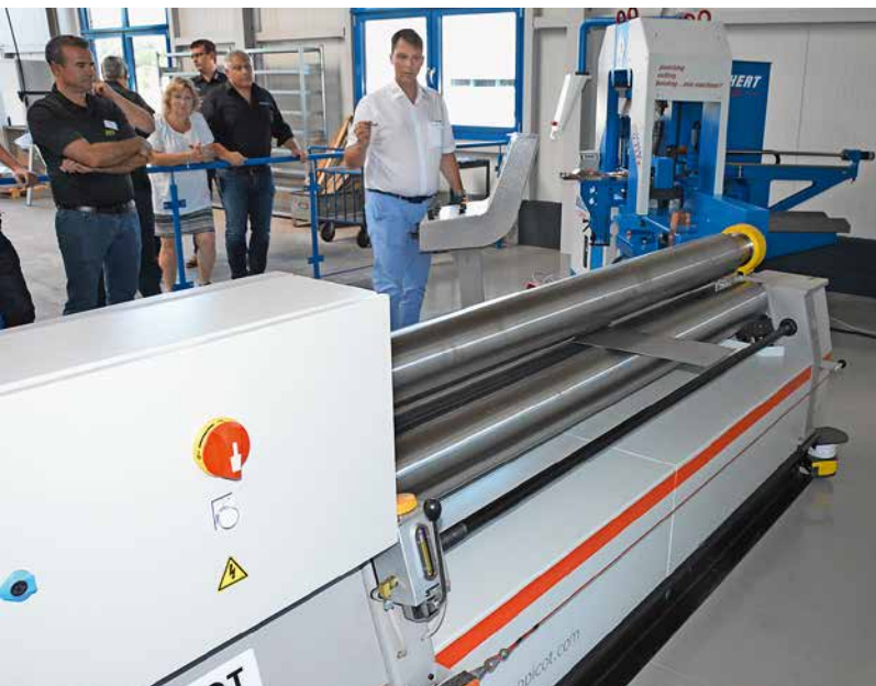
Die Easy-Roll Walzbiegemaschinen von AMB Picot arbeiten mit drei Walzen und einer Steuerung, die das automatische Walzbiegen ohne Korrekturen durch den Bediener ermöglicht. Bild: Albrecht
