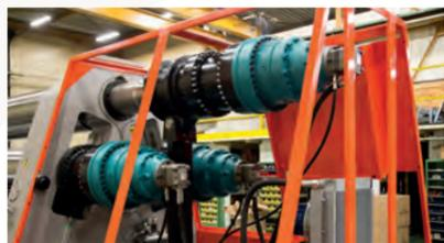
Un moteur (moto-réducteur) par rouleau de série. Nous équipons nos machines de moteurs DanPass depuis plus de 35 ans. Les rouleaux sont synchronisés en rotation à l'usine par un dispositif hydraulique qui évite toute variation à travers le temps.
